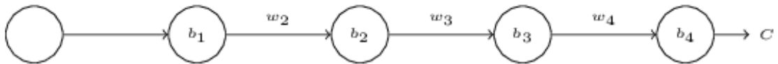
Abbildung 5: Vereinfachte Form eines tiefen Neuronalen Netzes mit nur einem Neuron pro Schicht. [Nie]
