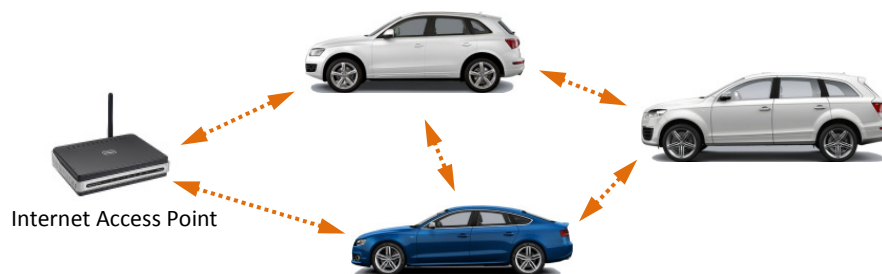
Abbildung 6: MANET mit Zugang zum Internet
