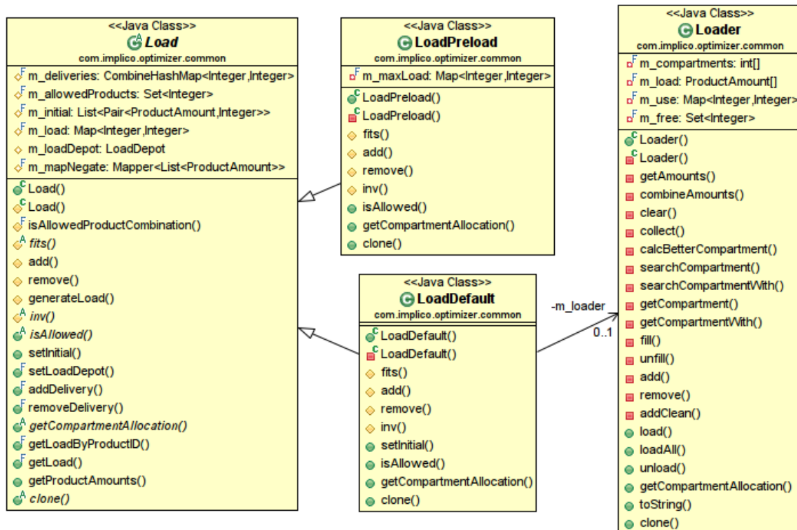
Abbildung 5.6.: UML-Diagramm zur Beladung der Fahrzeuge
