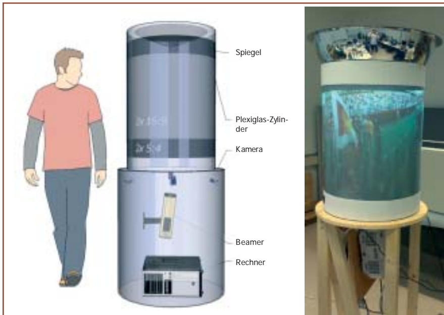
Abb. 3: Skizze und Prototyp des ersten zylinderförmigen, Multitouch-fähigen Systems
