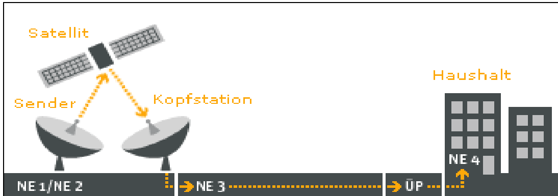
Abbildung 3-1: Netzebenen im Kabelrundfunk
